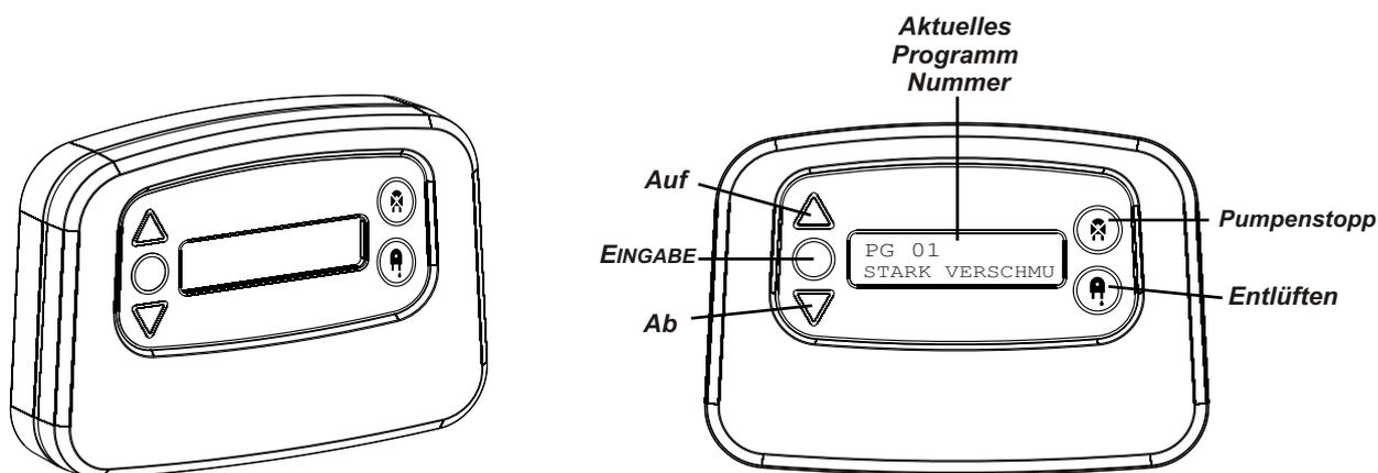
Das Modul an einer geeigneten Oberfläche mit Hilfe des mitgelieferten Klebebands (Klettverschlussband) in einem zugänglichen Bereich anbringen.
