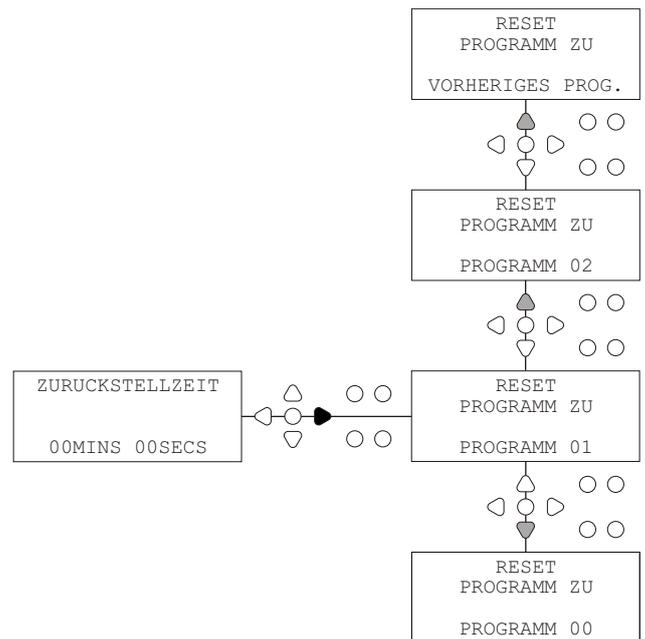
Nur zum Einsatz mit computergesteuerten (intelligenten) Zentralmaschinen ermöglicht der Modus AUTOMATISCHE FORMELAUSWAHL die automatische Auswahl von Programmen (Formeln) ohne ein Formelauswahlmodul zu benötigen. Sie können zwischen der binären Betriebsart und der Zeitsteuerung wählen.
