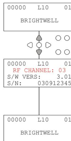
Um auf den TESTMODUS zuzugreifen, zunächst den Strom an der Einheit abschalten. Dann die Taste **TEST** drücken und gleichzeitig den Strom an der Einheit einschalten. Nach Starten der Einheit befindet sie sich im TESTMODUS.
