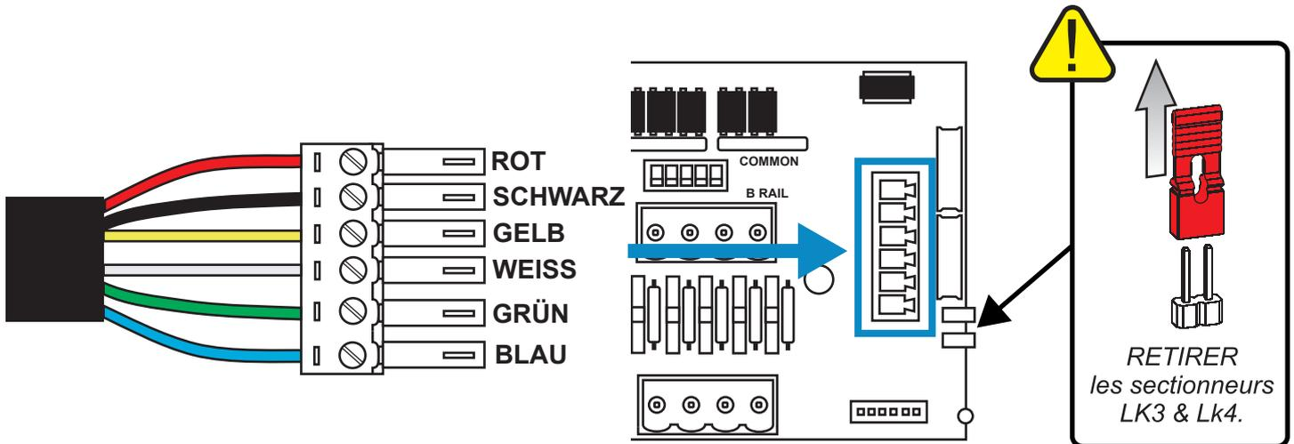
Den grünen Anschluss anbringen, wobei sich die farbigen Drähte in der oben gezeigten Reihenfolge befinden müssen. Den Anschluss in die richtige Buchse einsetzen und die Stopfbüchse zur Befestigung des Kabels festziehen. **TRENNEN der Verbindungen LK3 & Lk4.**
