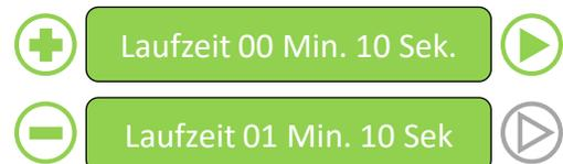
**Schritt 18:** Der Anfangsbefüllung Zähler zeigt die Gesamtanzahl der Anfangs Befüllungen an. Durch Drücken der Plus- oder Minustasten werden Gesamtlaufzeit oder Gesamtanzahl angezeigt. Wenn Sie die Plus- oder Minustasten gedrückt halten, werden die Zähler zurückgesetzt.
