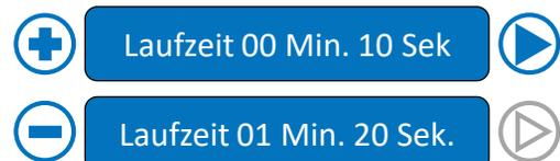
**Verzögerung Pumpe 2** – Konfigurierbare Verzögerung der Spülung, wenn das Signal für Pumpe 2 am EINGANG FÜR PUMPE 2 gemessen wird. Die Pumpe wird erst nach Ablauf der Verzögerung in Betrieb genommen.
