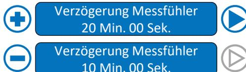
**Messfühleralarm** – Konfigurierbarer Alarmzeitpunkt. Sollte die Pumpe länger als die im Messfühleralarm festgelegte Dauer betrieben werden, wird Pumpe 1 abgeschaltet und ein Summer, sowie eine Warnleuchte, zeigen an, dass möglicherweise ein Problem mit dem Wasserstand oder der Chemikalienzufuhr besteht.
