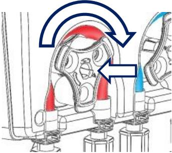
Das Diagramm zeigt den Pumpenkopf der Einheit, der mit einem roten Schlauch verbunden ist. Ein Pfeil zeigt im Uhrzeigersinn, was die Drehrichtung des Pumpenkopfes anzeigt.                                                                                          |
