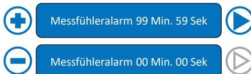
**Zurücksetzung des Messfühleralarms** – Mit dem Zurücksetzung des Messfühleralarms kann der Benutzer entweder eine manuelle Zurücksetzung einstellen, bei dem irgendeine Taste gedrückt werden muss, wenn der Messfühleralarm aktiviert wird um den Zustand zurückzusetzen. Auto sucht nach einer Konzentrationsänderung, während das Waschsignal hoch ist, bevor der Alarmzustand automatisch zurückgesetzt wird.
