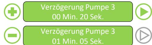
**Verzögerung Pumpe 3** – Konfigurierbare Verzögerung der Spülung, wenn das Signal für Pumpe 3 am EINGANG FÜR PUMPE 3 gemessen wird. Die Pumpe wird erst nach Ablauf der Verzögerung in Betrieb genommen. Hinweis: Diese Option wird nur angezeigt, wenn festgelegt wurde, dass die Einstellungen für Pumpe 3 NICHT von Pumpe 2 übernommen werden sollen.
